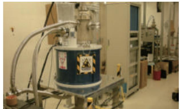
図1a) 700MHz DNP-NMR分光のための460GHzジャイロトロン装置2台
